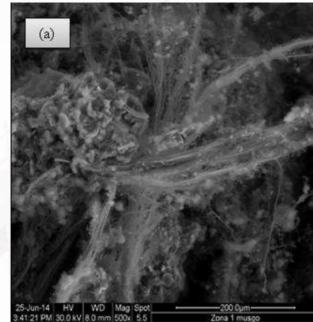
Fibra de Actinolite com ampliação de 500X Fonte - Faria, Catarina
