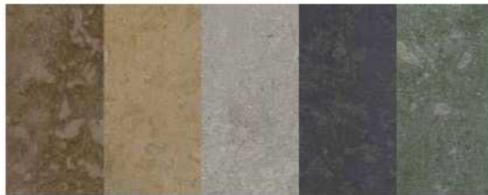
Painéis de betão incorporando pó de vidro reciclado e pigmentos
